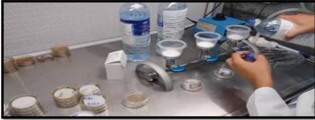
Figure 30: Filtration de l'eau dans la rampe de filtration.
