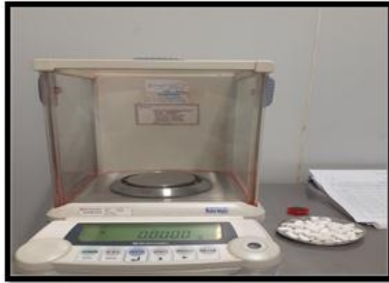
Figure 31: Balance analytique de type SHIMADZU A UW320.
