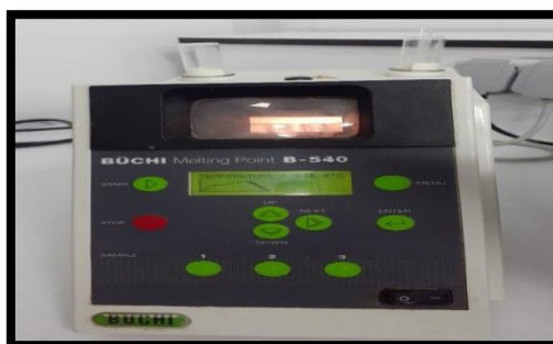
Figure 23: Fusiomètre de type BUCHI Melting point B- 540
